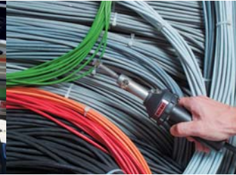
Anbringen einer Lötshrumpfverbindung mit HOT JET S und aufgeschobenem Siebreflektor.
